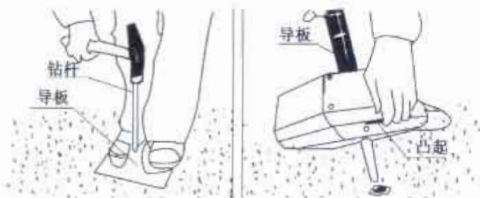
图 T 0922-2 在路表面上打孔的方法
